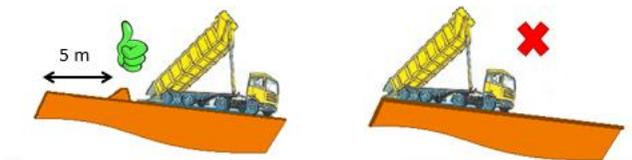
Il est interdit de benner en bordure de plate-forme élevée sans merlon de sécurité.
